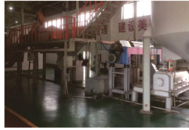
中圣-三相磁碟离心机可对高温水解后的餐厨垃圾，可实现“固相”（废渣）、“轻液相”（地沟油）以及“重液相”（餐厨水）的三相分离，具有结构紧凑、高效、全封闭、占地小、环境好、自动化水平高等优点。
