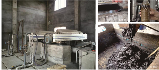
中圣-油田专业三相磁碟离心机在三相处理中显示出很大的优越性，在投加表面活性剂、稀释剂、破乳剂、润湿剂等调节剂，并辅以加热减粘等调质后，可以将油泥中的固体分离出来，而且还可以将油泥中的污水分离出来，这是其他分离法不可比拟的。同时经三相磁碟离心机处理后的干泥含水率、含油率有不同程度的下降。通常情况下干泥含水率可在65%左右，含油率可在3%左右。由于干泥含水率降低，一方面减少了投用量，降低了拉运成本；另一方面减少了进入自然环境中的油泥量，降低了对环境的污染。干泥含油率的降低无疑减少了进入自然环境中的有机物，有利于环境的自然净化。另外由于三相磁碟离心机能够进行固-液-液分离，水中含油率大大降低，可在4-6%左右，液相含油率大大降低，分离出的污水可直接进入污水系统，减轻了后续工段负荷，节约了污水处理成本。
